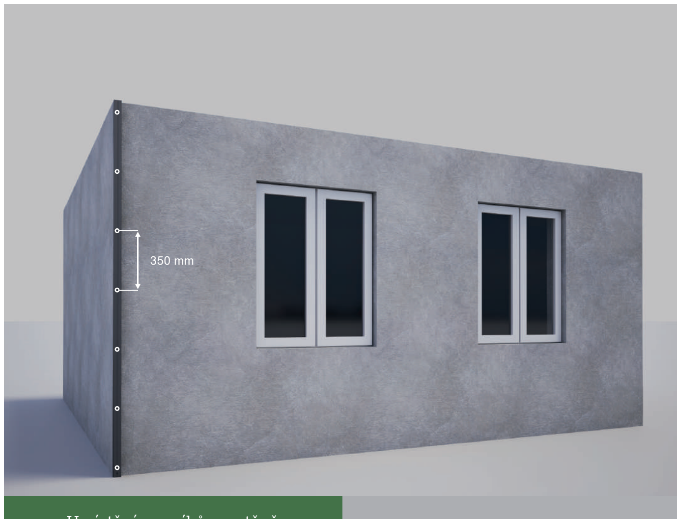
Umístění nosníků na stěně
