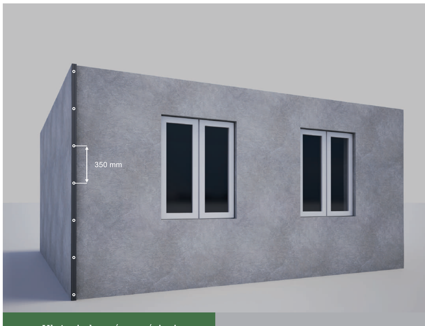
Ułożenie legarów na ścianie
