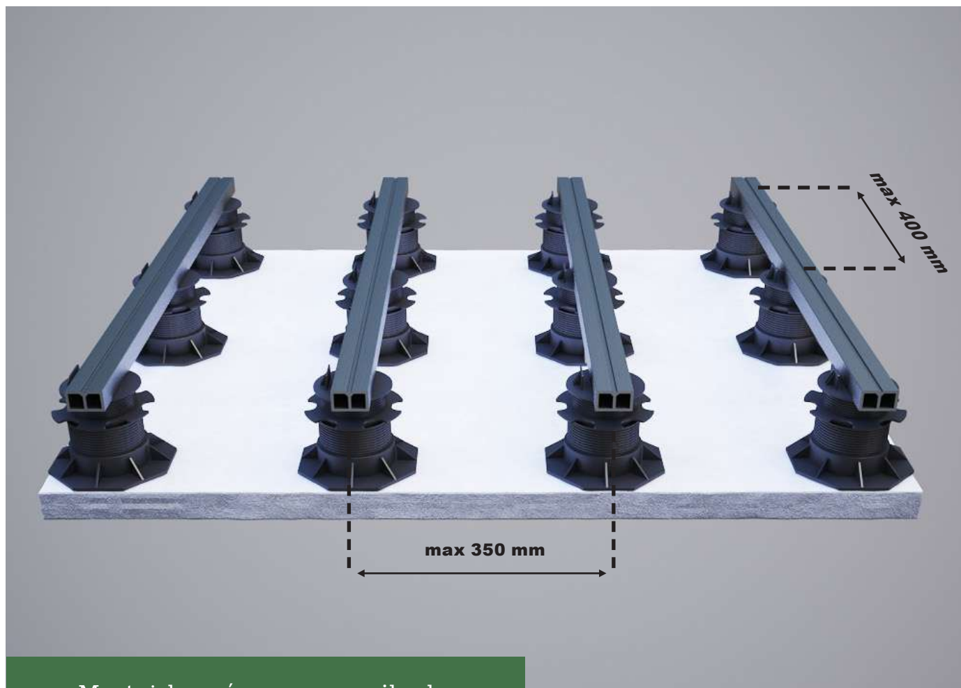
Montaż legarów na wspornikach
